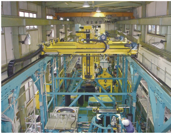
工場内での工業用ベルト生産ラインの組立作業
