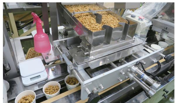
納豆菌をかけた豆がパックに充填される工程
