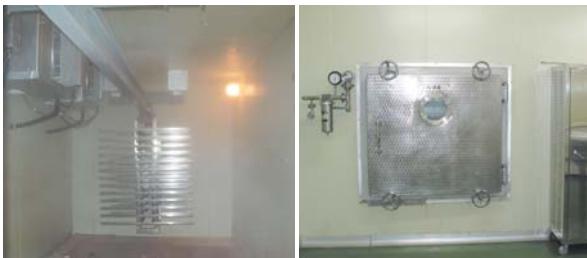
マイナス40℃程度で物質を急速凍結する（左） 真空凍結乾燥機で真空にし一気に水分を昇華（右）
