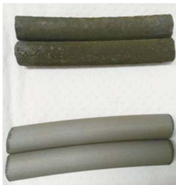
酸化被膜に覆われた炭素鋼（上）とCO-5洗浄後の炭素鋼（下）
