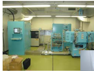
アンバランスド・マグネトロン・スパッタリング成膜装置（上）と、コーディネーターが常駐する拠点事務室（テレビ会議室）
