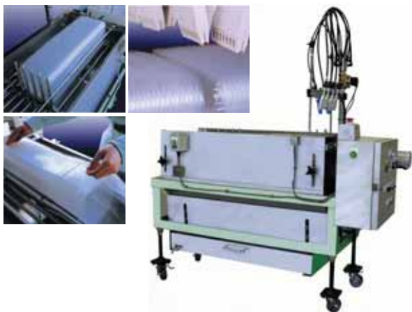
自社開発した「自動除塵包装機」
