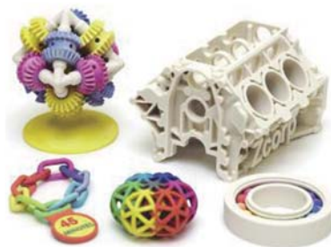
金型成型では造形不可能な複雑な形状も、フルカラーで簡単に製作可能（左）
