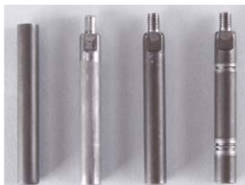
高度冷間圧造技術により各工程で加工された小型モーターのシャフト
