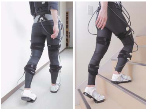
靴裏に小型計測器を装着し、坂道（左）や階段（右）での6軸（3軸荷重とモーメント）が計測できる移動式フォースプレート
