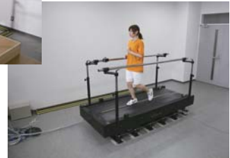
ランニング時の力学的解析に必要な6分力を計測するトレッドミル（下）
