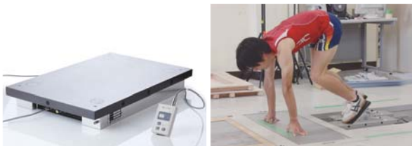
内蔵センサーやアナログ・デジタルの両出力を兼ね備えたアンブなど独自の技術と経験を活かしたフォースプレート（左）が陸上のスターティングブロックに使われている（右）
