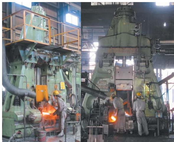
1.5トン エアードロップハンマー（左）と 4.0トン エアードロップハンマー（右）
