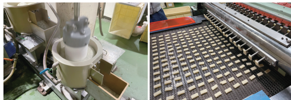
もち米を蒸した後、自動餅つき機で生地を作る（左） 分厚い生地の芯まで熱が入る高周波焼き機に入る前の生地（右）
