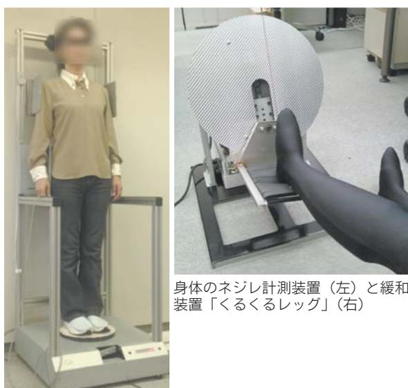
身体のネジレ計測装置（左）と緩和装置「くるくるレッグ」（右）
