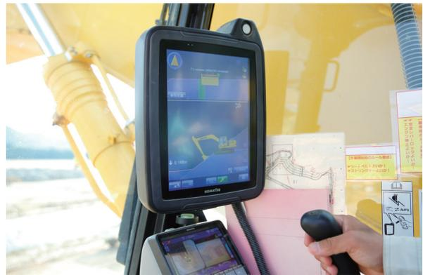
(上から) SCDashboard(ダッシュボード)/ICT 建機/情報化施工専用モニタ
